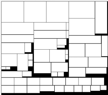
图6 基于贪心算法的人造板排样测试算例的最优排样 Fig.6 Greedy-detection algorithm test case optimal nesting
